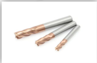
TiSiN Màu sắc: Vàng đồng Độ dày: 2~3 \mu\text{m} Ứng dụng: phủ mảnh dao, dao phay, mũi khoan,... Color: Bronze Thickness: 2~3 \mu\text{m} Application: coating cutters, milling cutters, drill bits,...
